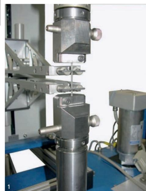
Prüfung einer mittels Micro Laser Sintering gefertigten Probe
